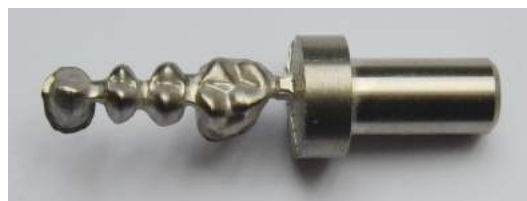
Armature de bridge en titane (coulée brute)
