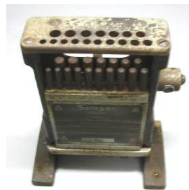
Appareil servant à la confection de couronnes estampées.
