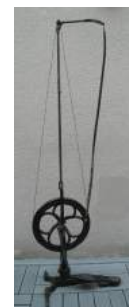
Le tour à pied, présenté par James B. Morrison en 1872, est encore utilisé couramment dans certains pays.
