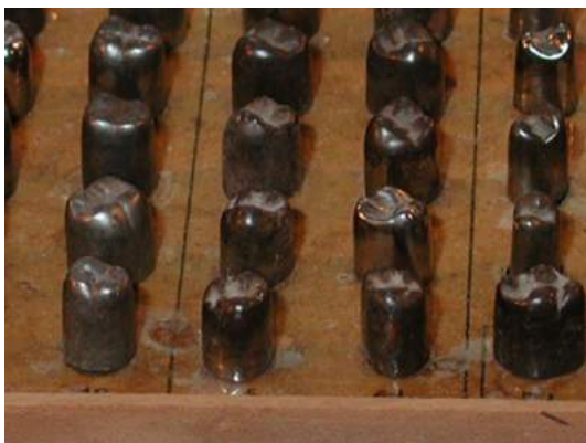
Boîte contenant un assortiment complet de 150 matrices pour fabrication de couronnes estampées. ( S.S.WHITE - U.S.A. ) (1910) ( 44 x 18 cm )
