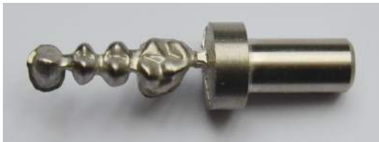
Armature de bridge en titane (coulée brute) destiné à être recouvert de porcelaine.
